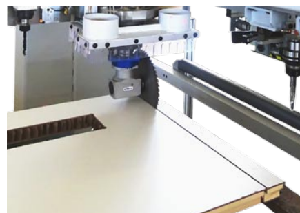
Распил панели + выполнение отверстий под стекло
