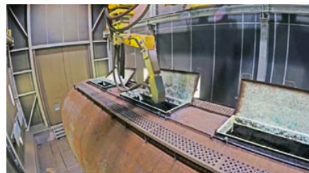
Ремонт железнодорожных вагонов с помощью роботизированной системы дробеструйной очистки
