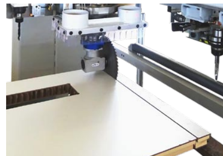
Распил панели + выполнение отверстий под стекло
