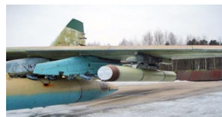
Варианты размещения контейнера АРТЗ «Сателлит» (слева направо): на самолете Су-27УБМ2; на самолете Су-25; на самолете МиГ-29
