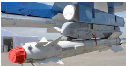
Варианты размещения контейнера АРТЗ «Сателлит» (слева направо): на самолете Су-27УБМ2; на самолете Су-25; на самолете МиГ-29
