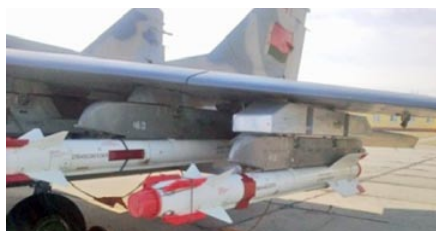
Варианты размещения контейнера АРТЗ «Сателлит» (слева направо): на самолете Су-27УБМ2; на самолете Су-25; на самолете МиГ-29
